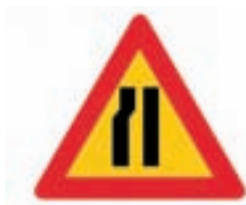
(Κ - 6α) Επικίνδυνη στένωση οδο- στρώματος στην αριστερή πλευρά.
