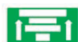
(Π - 84) Γέφυρα σήμανσης με αναγραφή κατευθύνσεων προ ανισόπεδου κόμβου με αφαίρεση λωρίδας του αυτοκινητοδρόμου.
