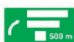
(Π - 84) Γέφυρα σήμανσης με αναγραφή κατευθύνσεων προ ανισόπεδου κόμβου με αφαίρεση λωρίδας του αυτοκινητοδρόμου.
