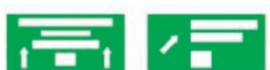
(Π - 85) Γέφυρα σήμανσης με αναγραφή κατευθύνσεων στην αρχή εξόδου από τον αυτοκινητόδρομο (αρχή λωρίδας επιβράδυνσης κόμβου).
